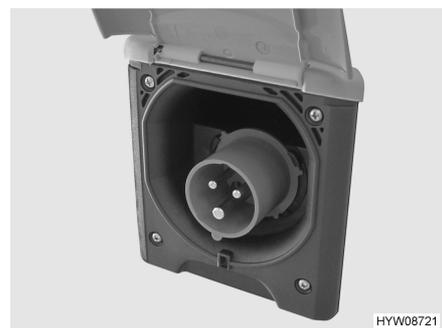
Bild 71 230-V-Anschluss am Fahrzeug (CEE-Steckdose)
