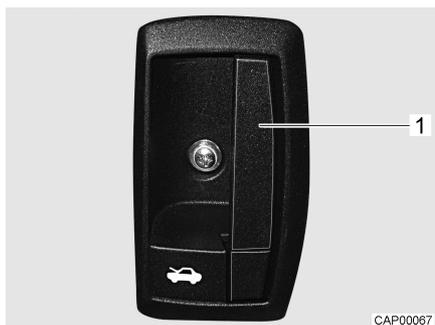
Bild 5 Entriegelungshebel (Motorhaube)
