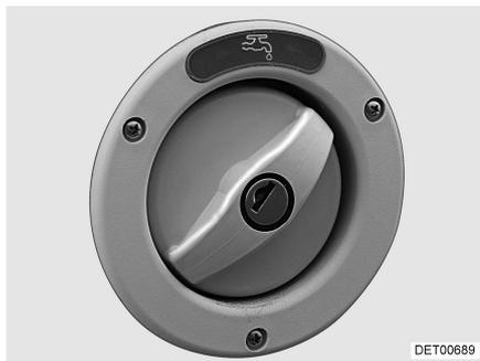
Bild 96 Verschlussdeckel für Trinkwasser-Einfüllstutzen
